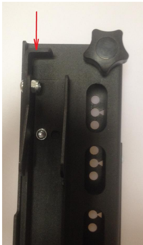
Рис.8 Фиксация стопорной планки. Левый кронштейн крепления.
