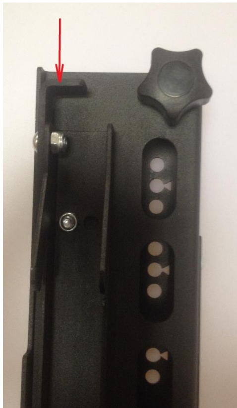
Рис.8 Фиксация стопорной планки. Левый кронштейн крепления.
