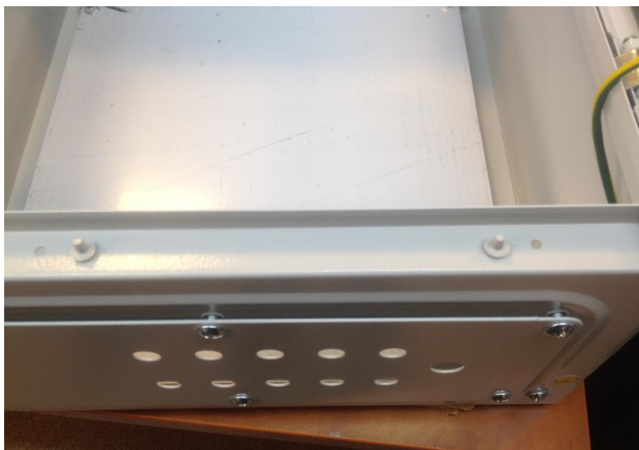
Рис.3.1.2-2 Резиновые заглушки вынуты из отверстий OS.
