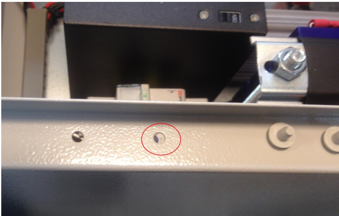
Рис.3.3.8-2 Резиновые заглушки вынуты из отверстий.
