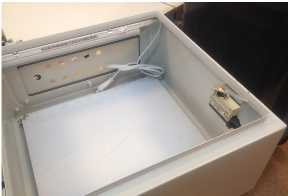
Рис.1-1 Пример совместной установки датчика вскрытия и светильника в уличную станцию OS-44XXX
