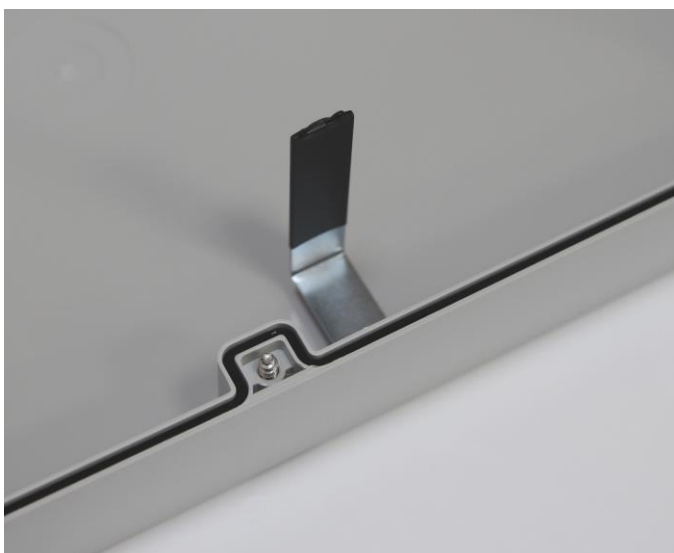
Рисунок 3.5.2 - Шторка датчика вскрытия на крышке блока
